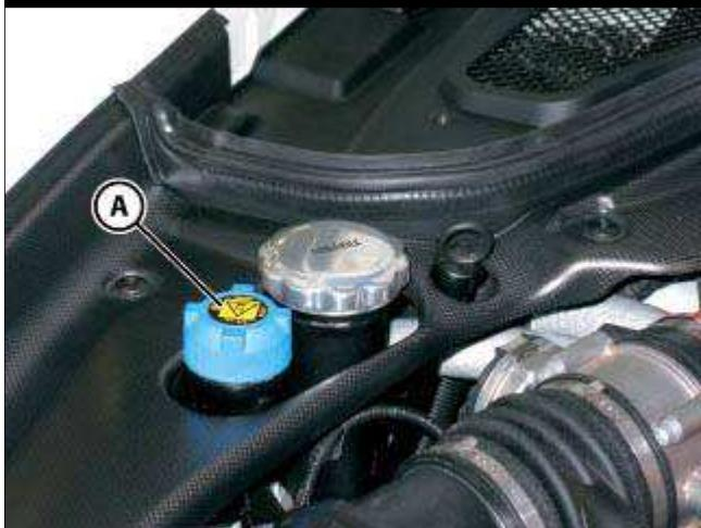
■ 将加注口盖 (A) 装回膨胀水箱上并拧紧。
