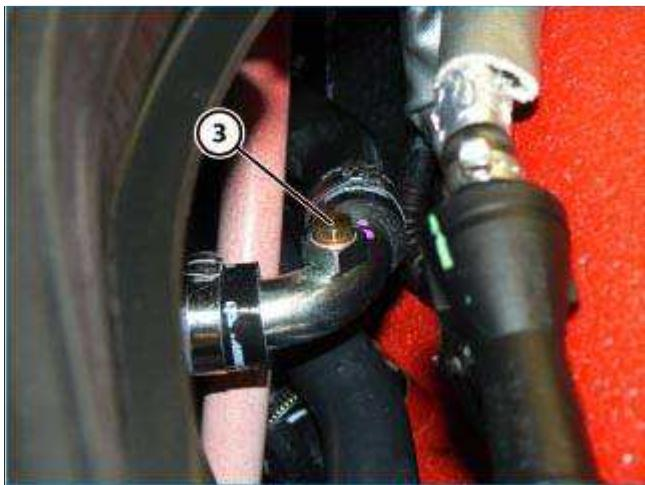
■ 关闭加热器管上的放气盖 (3)。
