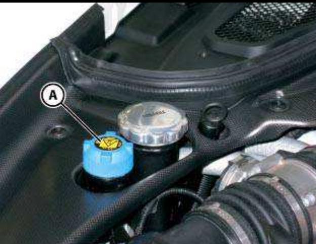
● 将加注口盖 **(A)** 装回膨胀水箱上并拧紧。
